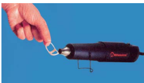
Värm i intervaller om 3-5 sekunder för att undvika överhettning. Undvik att värma direkt mot bandet på ringen.
